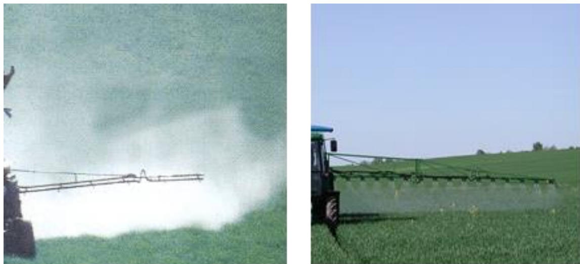
Joonis 4.1.3. Piiskade lendumine tava- (vasakul) ja venturi otsakutega pritsimisel
