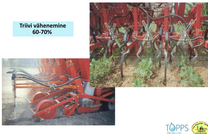
Joonis 4.7.1. Triivi vähendamiseks võib pritsimisega samaaegselt harida mulda.
