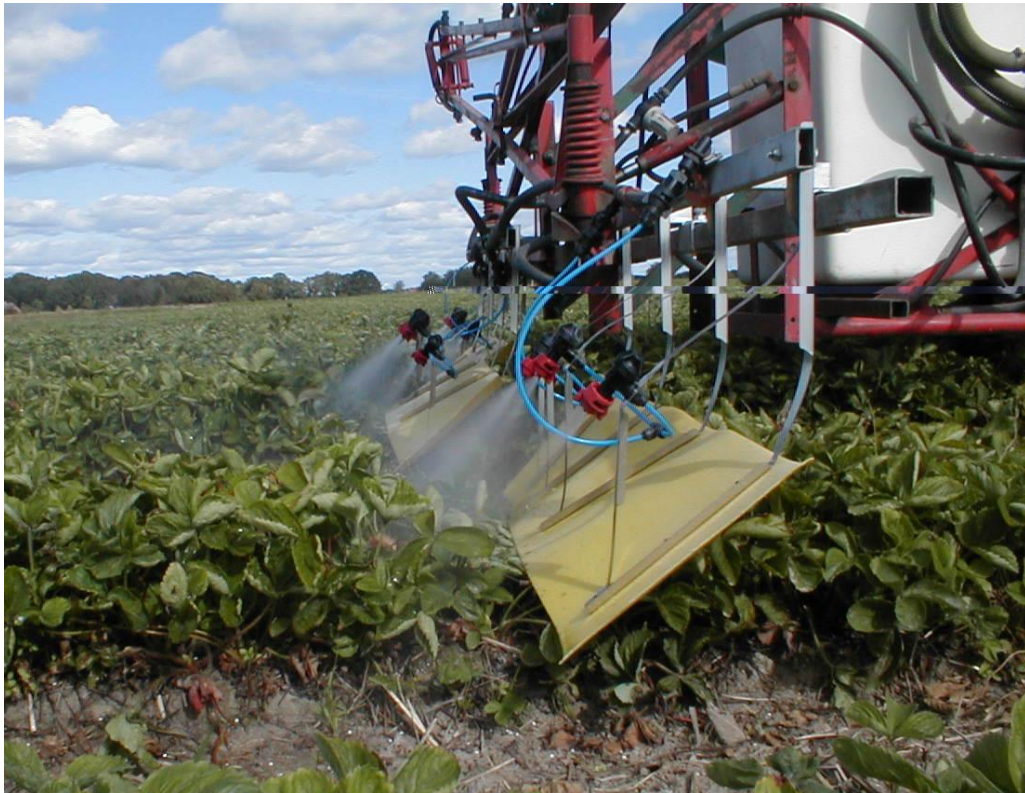
Joonis 4.6.1. Lohitsaga pritsimisel on triiv oluliselt väiksem.
