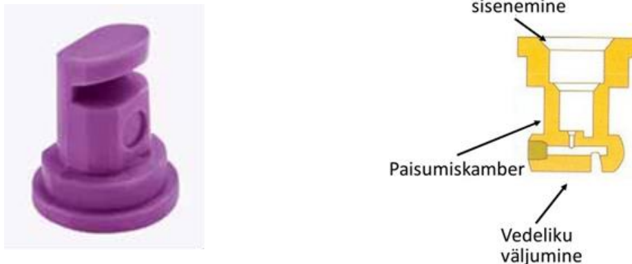
Joonis 4.1.4. Deflektorpihustiga pritsimisel võib triiv olla võrreldes tavapihustiga kuni 30% väiksem (Balsari et al, 2014).
