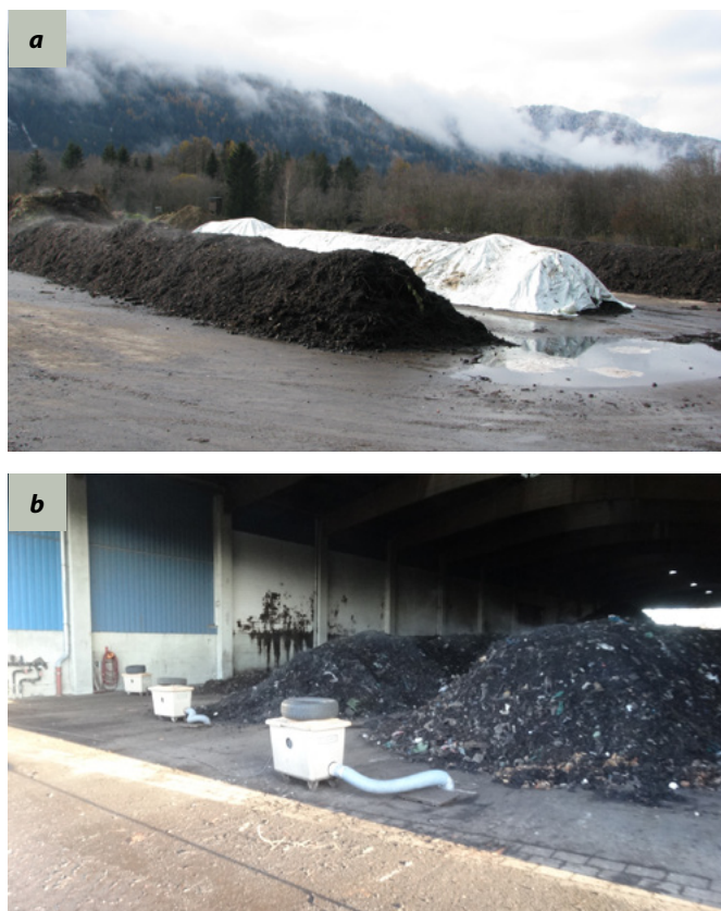
Joonis 2. Loomuliku õhustusega katmata ja katteriidealune aun (a) ning sundõhustatavad aunad (b)
