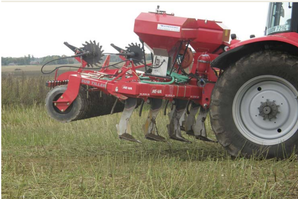
Otsekülvik-kobesti rapsi kasvatustehnoloogiasse rasketel muldadel
