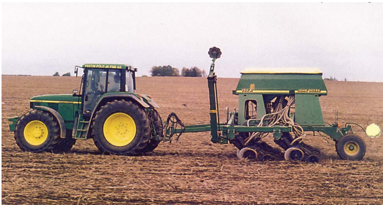
Otsekülvik John Deere Drill 750A – sobib hästi rohumaade pealtparandamiseks ja uuendamiseks
