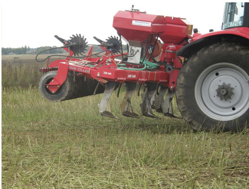
Otsekülvik-kobesti tihenenud muldadele talirapsi külviks
