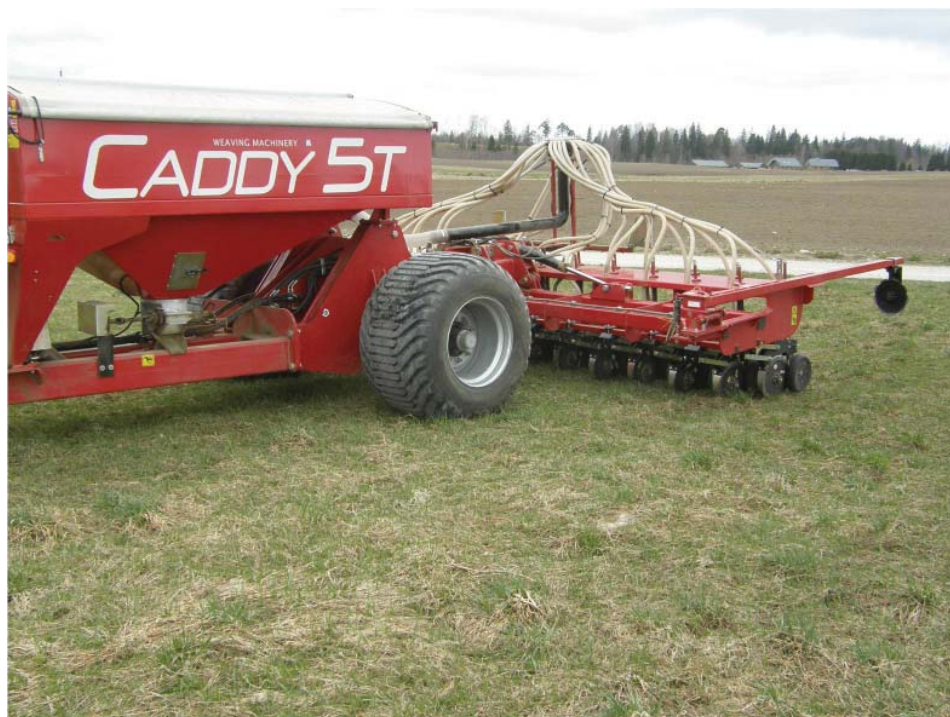
Mono-otsekülvik CADDY 5T reavahelaius 25 cm viib mulda ainult seemned
