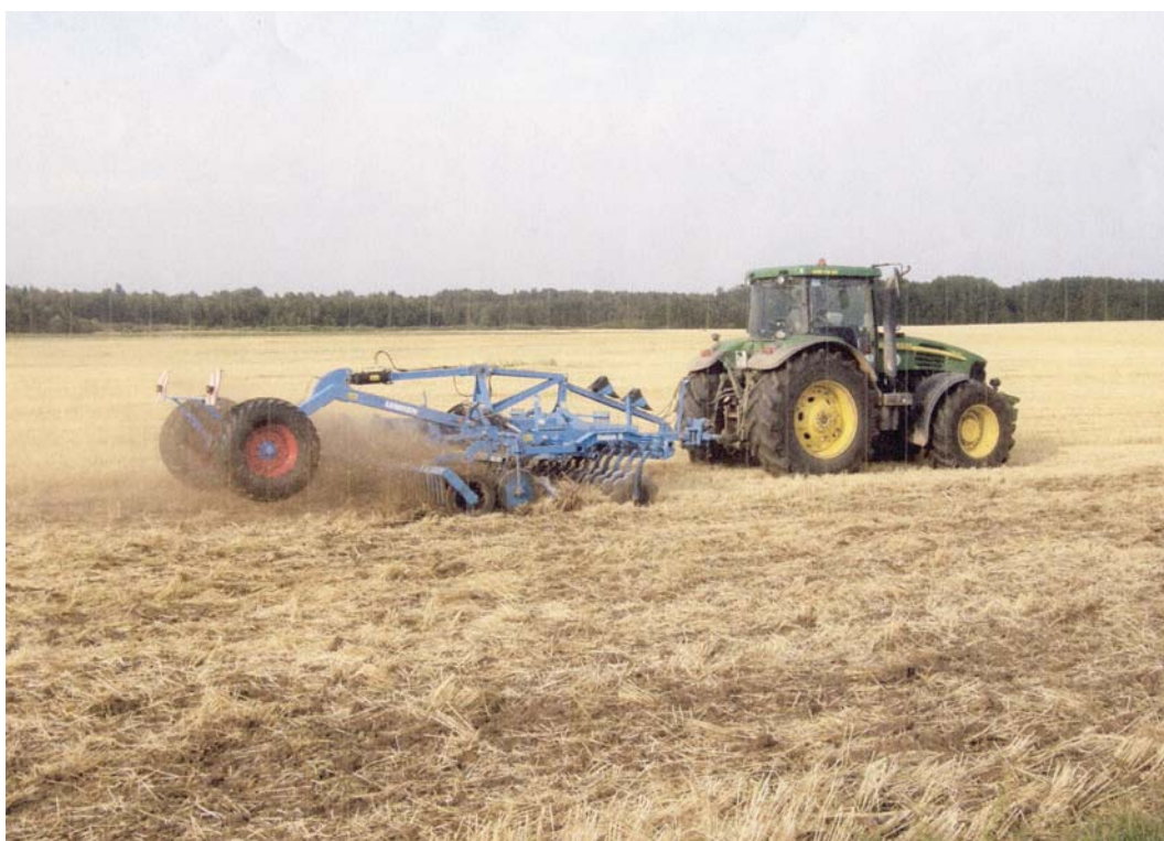
Rullrandaal põhu hajutamiseks ja mulda segamiseks
