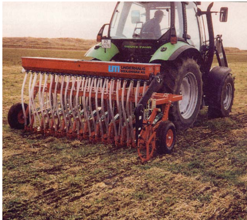
Heinaseemnete otsekülvik UM 7942 töölaiusega 2,5 m sobib rohumaadel taimekoosluse parandamiseks (liblikõieliste sissekülv) ja uuendamiseks
