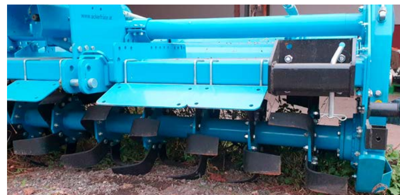
Gerhard Weißhäupli konstrueeritud mullafrees, millega mulda pindmiselt haritakse
