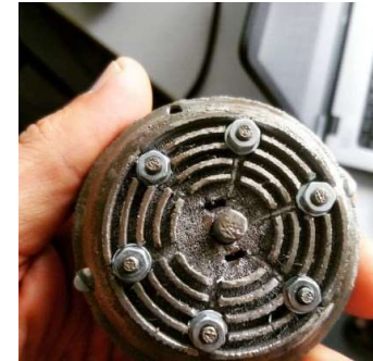
3D prinditud elektrimasin
