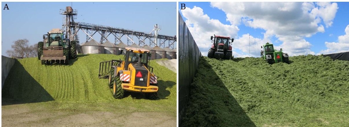
Foto 4.7. Optimaalne haljasmassi kihi tusedus ja masinvõimekus tihendamiseks (A) versus liiga paks kiht (B) (autor: A. Olt)
