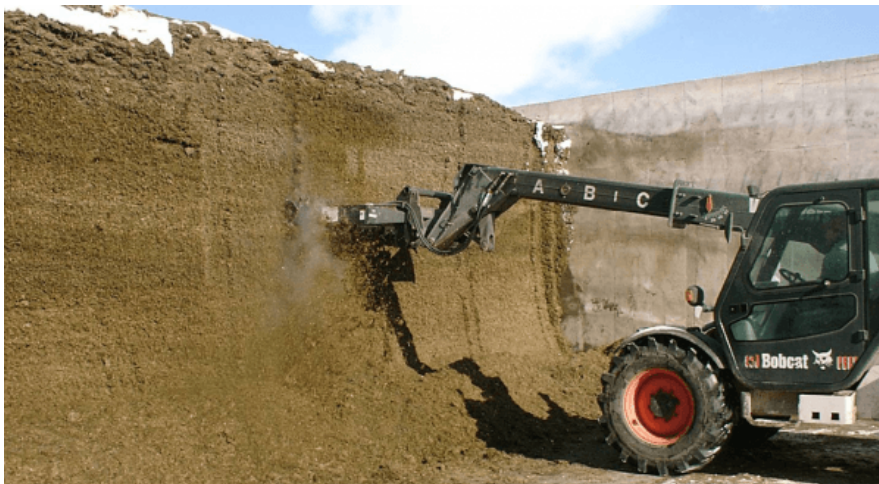
Foto 7.2. Sobiva silolõikuri kasutamine aitab vähendada söödajääke tranšee juures (allikas: internet)
