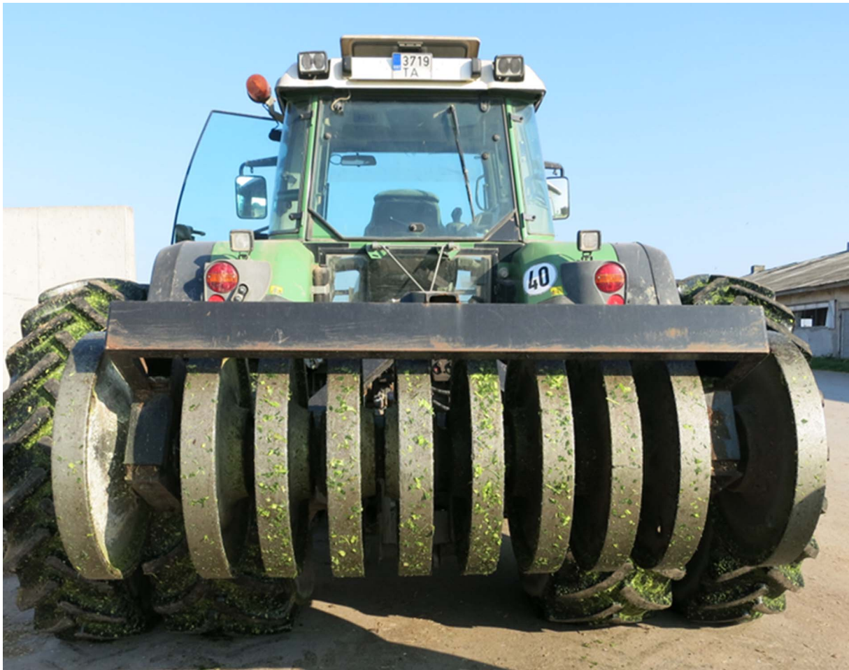
Foto 4.8. Haakeseadet traktori massi suurendamiseks, haljasmassikihi ühtlustamiseks ja tihendamiseks (autor: A. Olt)
