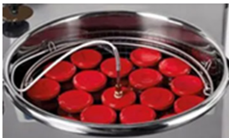
Kuvatõmmis 7. Tootesse paigutatud temperatuuriandur.
