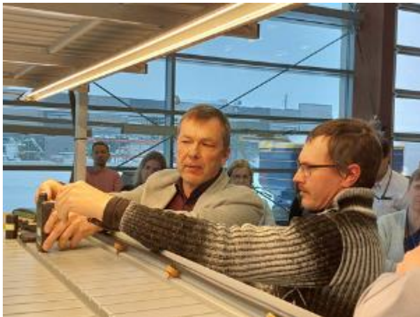
Vertikaalriulil valguse mõõtmine erinevate mõõteseadmetega
